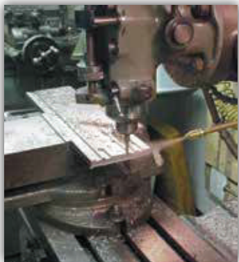
Enfriamiento con rocío en una operación de perforación
