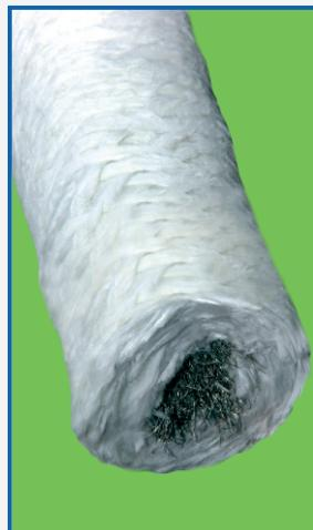
**DESCRIPCIÓN:** Sobre un alma trenzado de acero inoxidable 304 se trenzan capas utilizando hilos de fibra de vidrio conformando un conjunto flexible que a pesar de las altas temperaturas mantiene su resiliencia sin deformarse.
