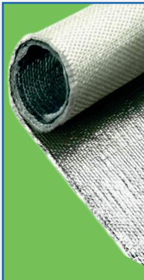
**DESCRIPCIÓN:** Se fabrica pegando una película metálica a la tela de fibra de vidrio por medio de un adhesivo resistente a la temperatura.
