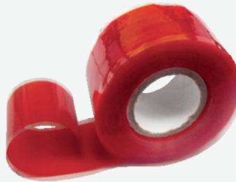
**DESCRIPCIÓN:** Es un polímero de silicona autovulcanizante que se une así mismo por presión, el cual una vez conformado forma una estructura única con excelente resistencia mecánica ideal para sellar escapes en tanques, tuberías o accesorios que manejan agua potable, aguas residuales, ácidos y bases débiles, amoniaco al 10%.
