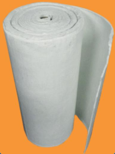
**DESCRIPCIÓN:** Manta aislante con las mas baja conductividad térmica de los materiales sólidos, flexible, ambiental, fácil de cortar, desarrollada para alta temperatura formada por sílice amorfa de 20 a 50 nanómetros (nanotecnología) soportada en una matriz de fibras inorgánicas (no asbestos) entrecruzadas; Ideal para aislar tanques, tuberías, ductos, equipos, etc por su alta eficiencia energética.
