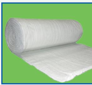
**DESCRIPCIÓN:** Fibras de vidrio tipo E, no combustibles, no respirables sin ligamentos orgánicos de excelente flexibilidad, resistencia química y baja conductividad térmica, se comprimen y ligan mecánicamente, sin adición de adhesivos, para conformar un tejido entrecruzado flexible de muy buena resistencia mecánica de fácil corte excelente para conformarse en diferentes configuraciones.
