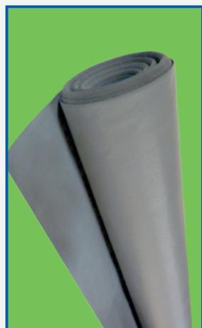
**DESCRIPCIÓN:** La tela de fibra de vidrio tejido plano se somete a un proceso de coextrusion laminación con PTFE en las dos caras para conformar una tela antiadherente químicamente inerte resistente a la mayoría de productos químicos excepto a los alcalinos derretidos.
