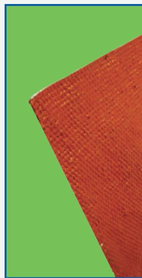
**DESCRIPCIÓN:** Se aplica una capa gruesa de silicona roja sobre tela 100% de fibra de vidrio, obteniéndose un tejido no inflamable de excelente flexibilidad y resistencia al ozono ideal para proteger equipos de la chispa de soldadura y de las esquirlas de pulido ,etc.
