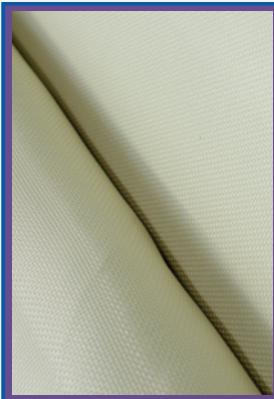
**DESCRIPCIÓN:** Tejido plano fabricado con hilos paraaramídicos de excelente resistencia mecánica, baja conductividad térmica.
