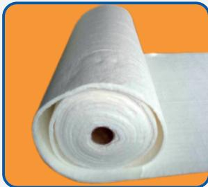
**DESCRIPCIÓN:** Fibras de silice amorfas. Tipo filamento con sección de nueve micrones de excelente resistencia térmica y baja conductividad térmica, se comprimen y ligan mecánicamente, sin adición de adhesivos, para conformar un tejido entrecruzado flexible de muy buena resistencia mecánica, de fácil corte excelente para conformarse en diferentes configuraciones.
