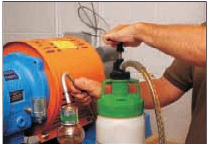
La codificación de los lubricadores Opto-Matic con collares Spectrum aseguran que el lubricante correcto se está utilizando.
