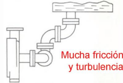
Las conexiones bridadas y codos deben reducirse al mínimo en la succión para evitar turbulencias.
